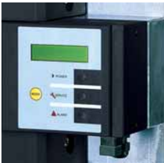
Die Steuerung Ultrapac 2000 Superplus . Display zur Klartextanzeige des aktuellen Betriebszustandes. Anzeige des optimalen und kostengünstigsten Austauschzeitpunktes für die Trockenmittelkartuschen. Mit potentialfreiem Kontakt für eine externe Signalisierung.
