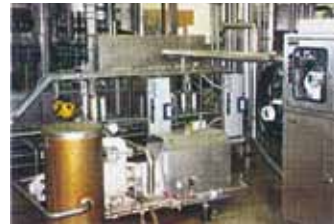
Deux sécheurs Ultrapac 2000 installés dans une usine d'embouteillage
