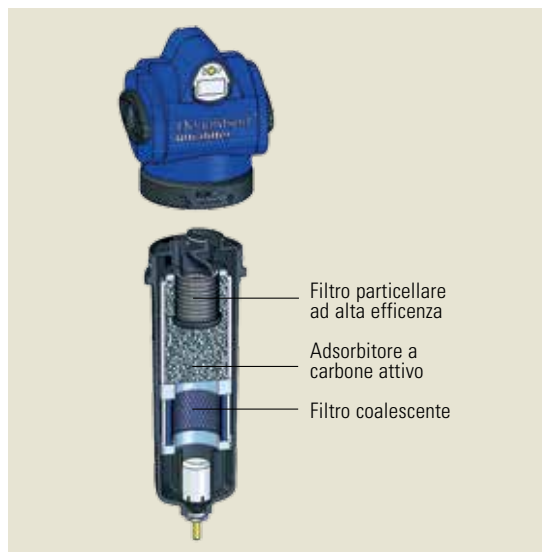
Sezione di un Ultra-Filter con element DF-T
